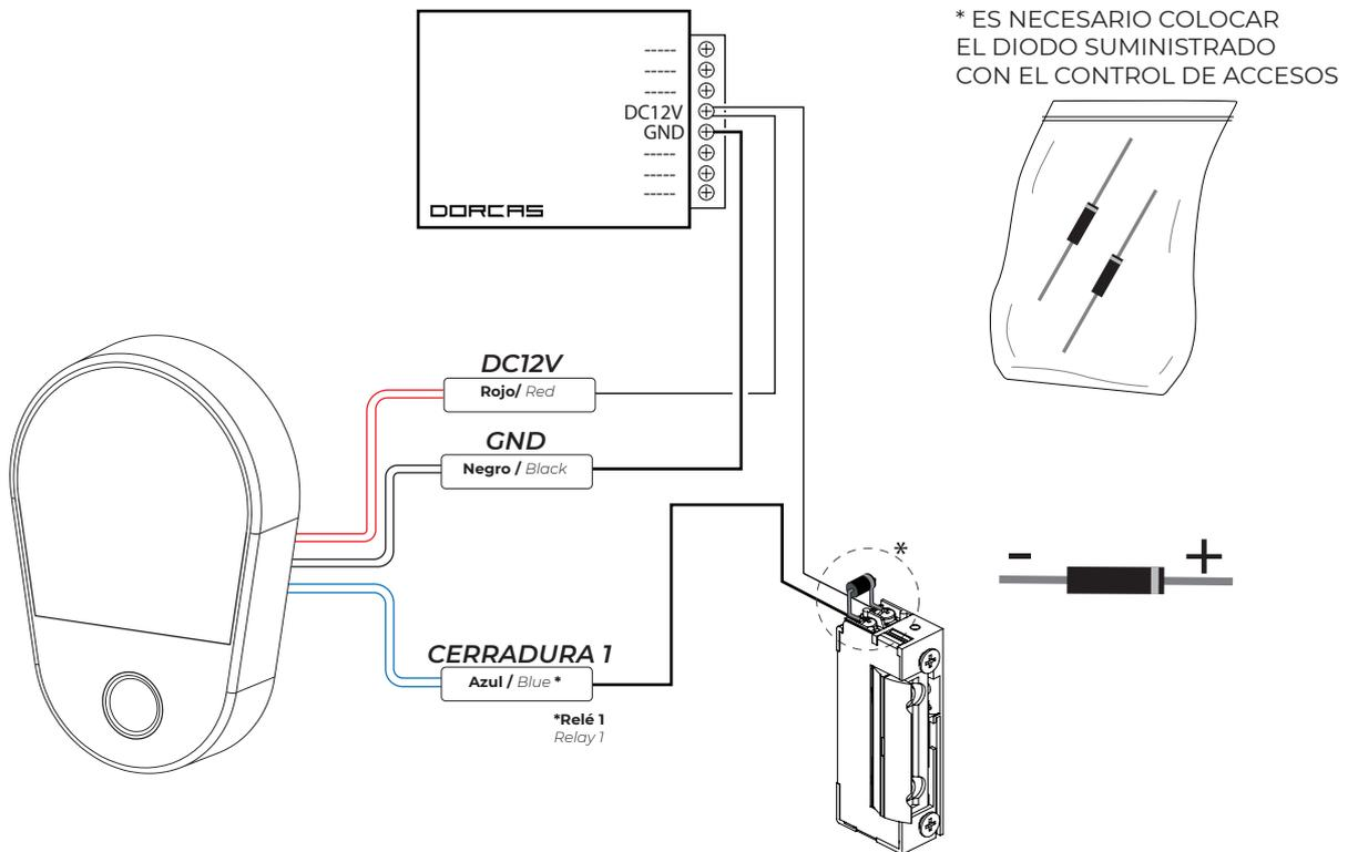
CONEXIÓN DE UNA **VENTOSA ELECTROMAGNÉTICA** O DISPOSITIVO QUE DESBLOQUEA AL INTERRUMPIR CORRIENTE ELÉCTRICA.
